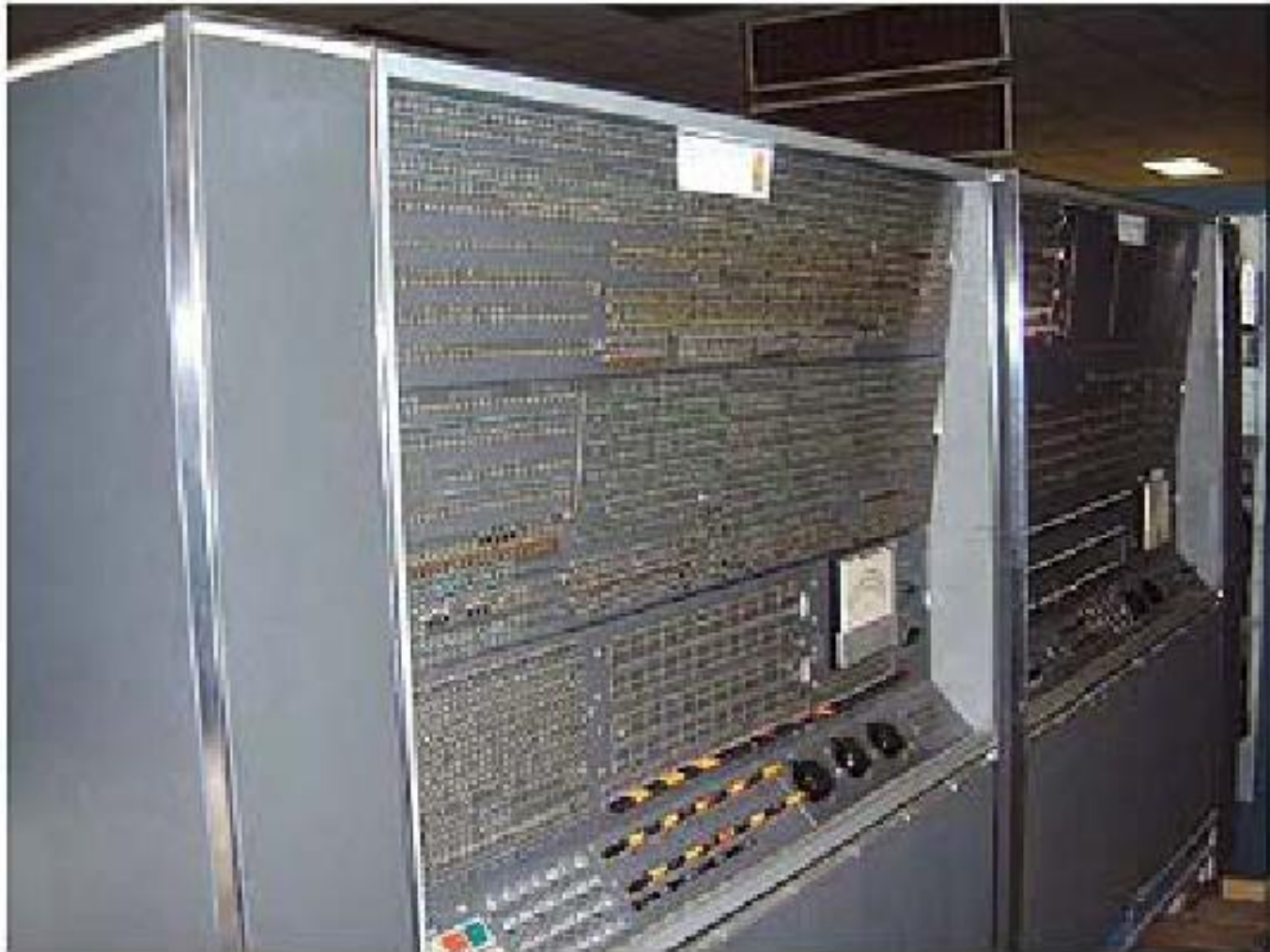
Máy IBM 7030 chứa 150,000 transistor (1959)
